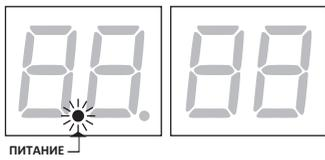
Этот режим активируется через 30 мин. после подачи последнего сигнала на вход блока и при неактивных системах безопасности. При этом индикатор питания медленно мерцает. Нажать UP ▲, DOWN ▼, + или - для активации дисплея.
