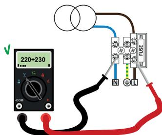
Измерение питающего напряжения при помощи тестера.
