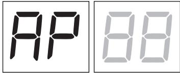
ТОЛЬКО в случае, если соответствующая команда активна (AP, CH, PP, PE, OR) состояние входов отображается в левой части дисплея в течении 5 сек. Например: если активна команда ОТКРЫТЬ, на дисплее отобразится надпись AP.
