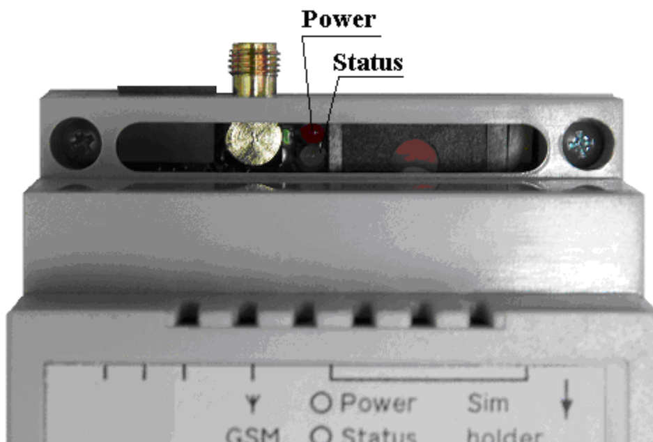
Рисунок 7. Індикація контролера («Power» «Status»)
