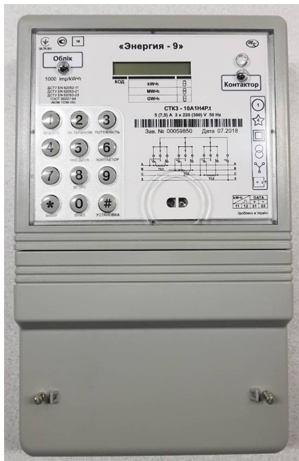
Рисунок В.1. Зовнішній вигляд лічильника з встановленою кришкою клемної колодки
