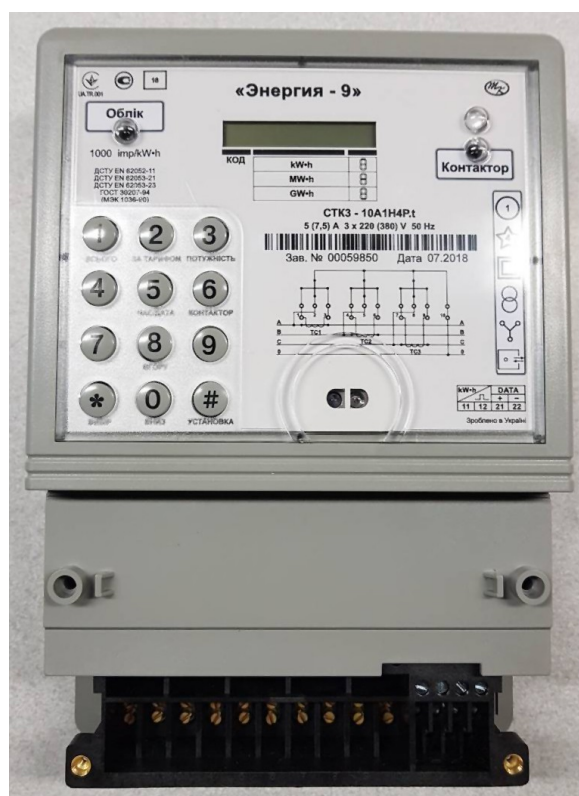
Рисунок В.2. Зовнішній вигляд лічильника зі знятою кришкою клемної колодки
